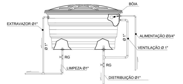
01 PLANTA DE INSTALAÇÃO HIDRÁULICA
